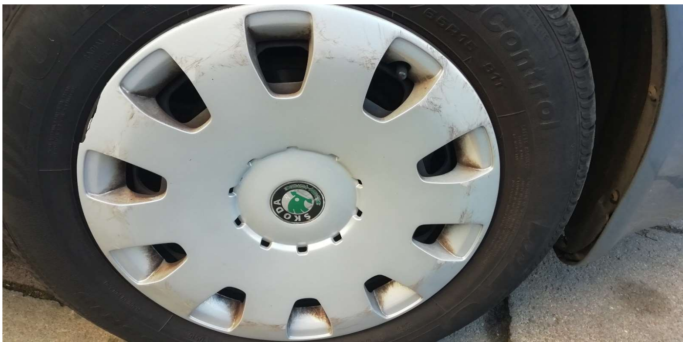
Ryc. 25. Uszkodzenie kołpaka koła przedniego prawego
