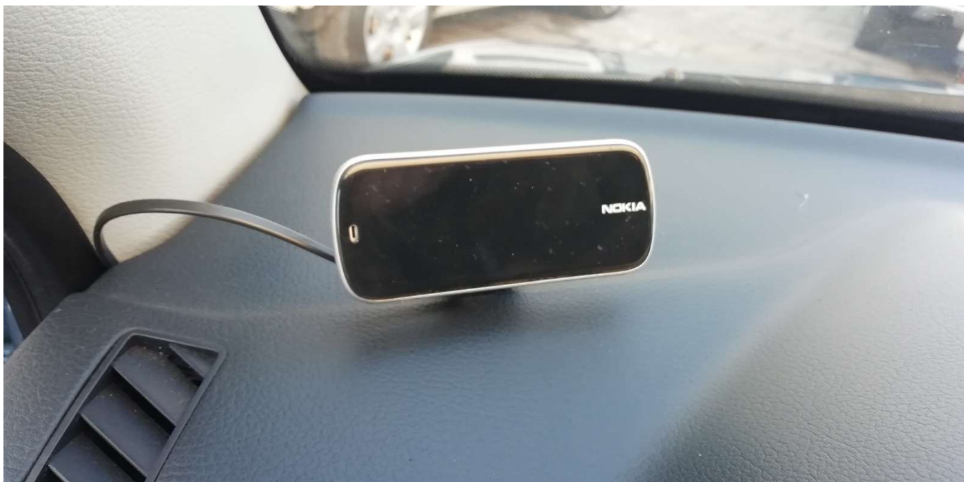
Ryc. 18. Wyświetlacz instalacji GSM
