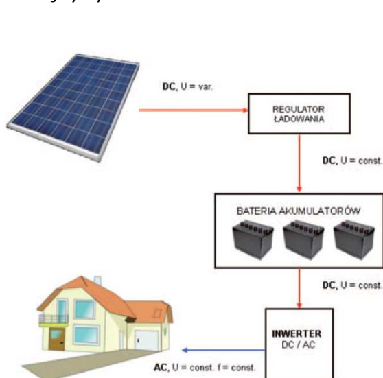
Rysunek 26 Schemat instalacji OFF-GRID 166 (oznaczenia: DC- prąd stały, AC-prąd przemienny, U- napięcie, f-częstotliwość, var.-zmiennie, const.- stałe)
